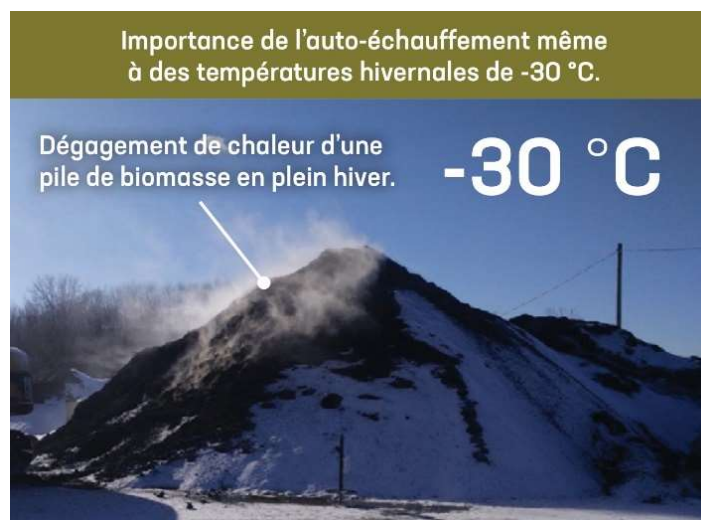
Figure 1. Présence d'auto-échauffement dans un empilement de biomasse à de faibles températures (Tiré de Helmeste et al., 2021).
