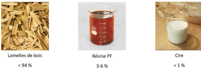
Figure 1: Composant d'un panneau OSB
