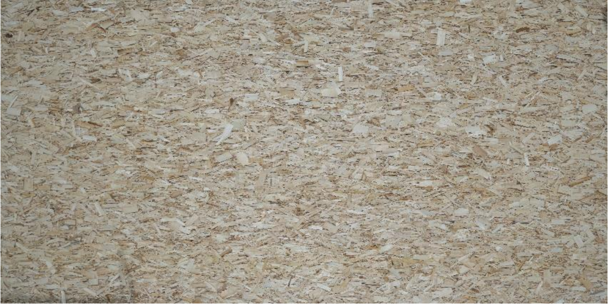
Figure 46 Ébauche d'OSB sur la ligne de production 4,88 m x 2,44 m.
