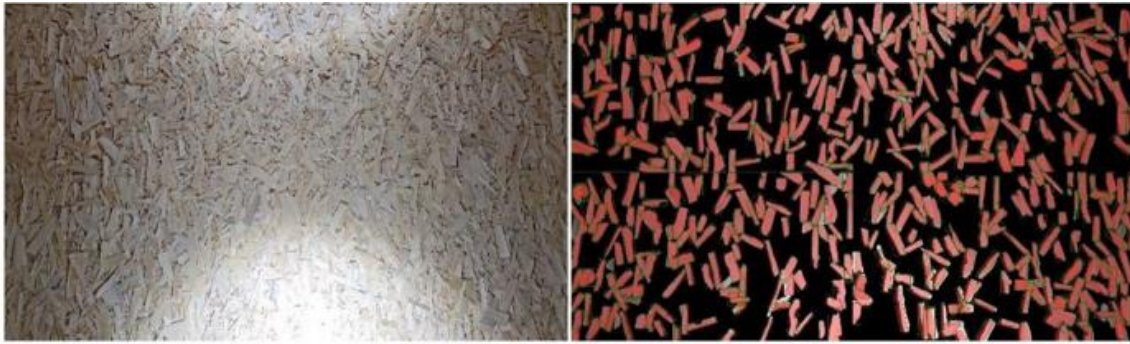
Figure 21 Images des lamelles sur la ligne de production (à gauche) et lamelles distinguées par la méthode automatique (à droite) (Hong et al. 2025).
