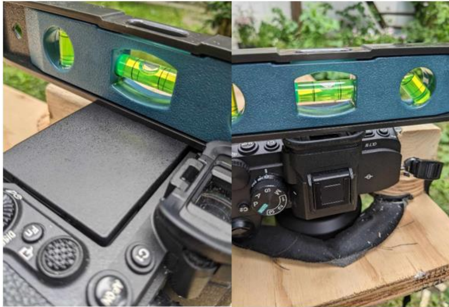
Figure 27 Caméra Sony A7 IV à niveau, sécurisée à la plateforme de mesure.
