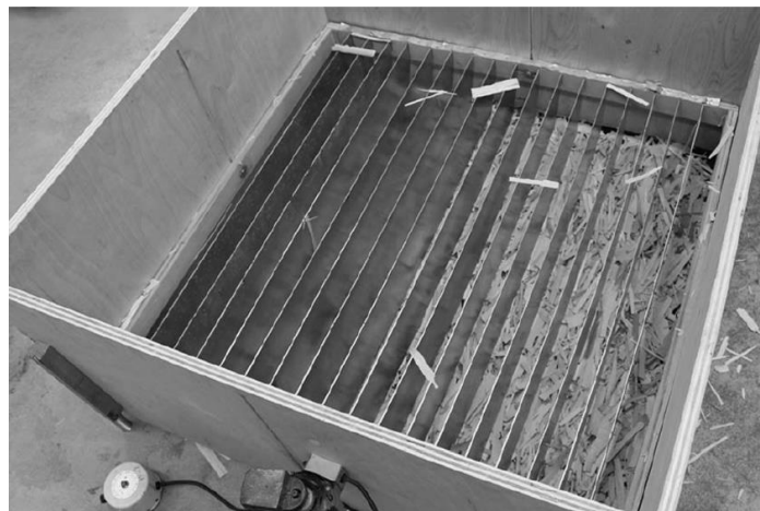
Figure 16 Boîte de formation vibrante utilisée pour la fabrication de panneaux OSB à orientation prédéterminée en laboratoire (Alldritt et al. 2014).
