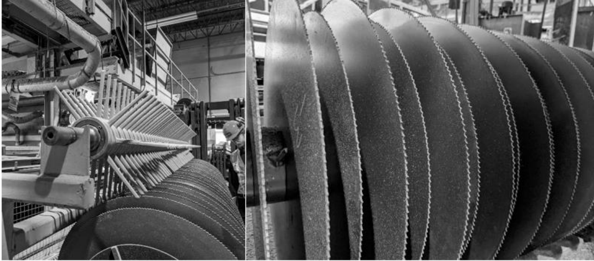
Figure 23 Balais et disques rotatifs d'une conformatrice industrielle.
